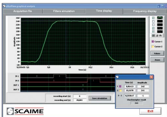
Visualisation du cycle de pesage dynamique avec le logiciel eNodView Display of checkweighing cycle with eNodView software
